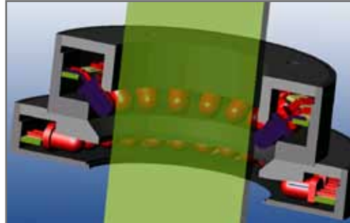
Kundenspezifischer Leuchtkopf im Schnitt
